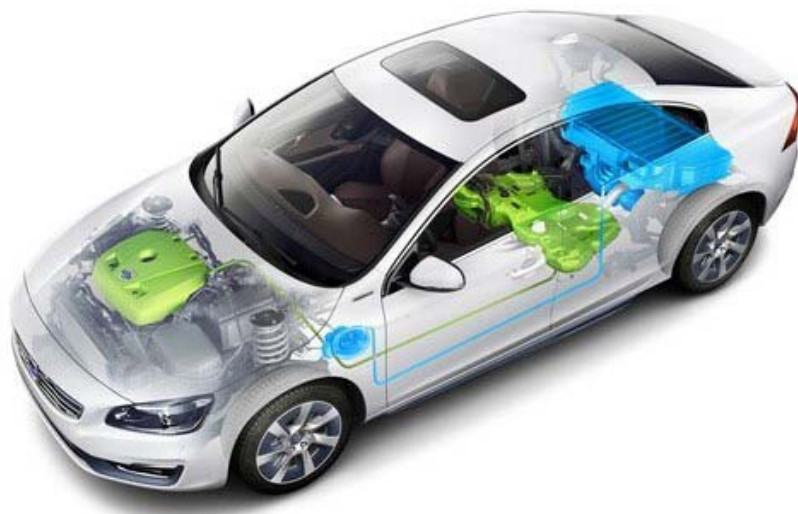
图一 动力汽车供电系统
