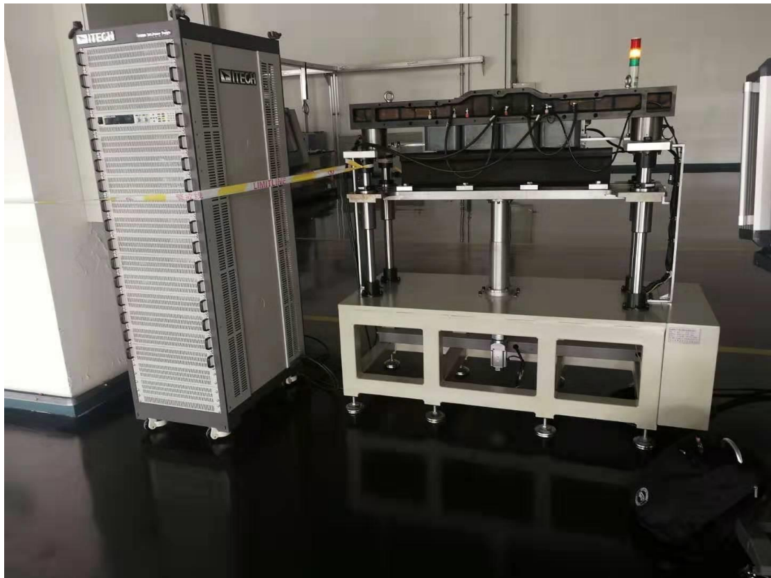
制动模块测试系统
