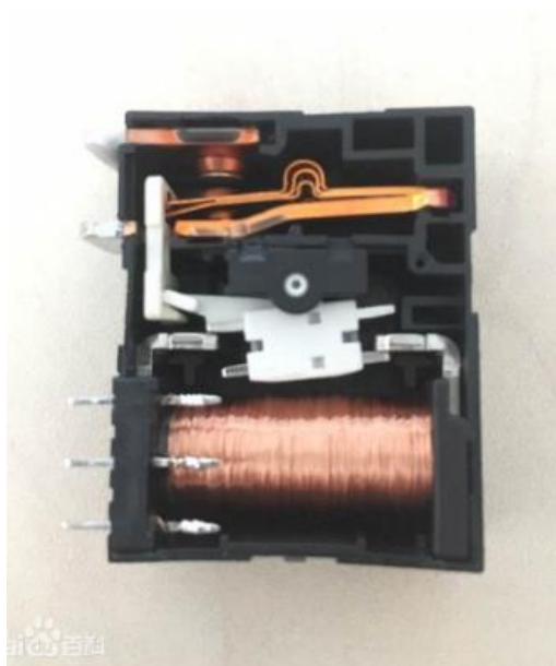
图 1 磁保持继电器内部图
