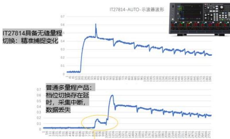
图 1 SMU 模组电流量程自动切换功能示意
